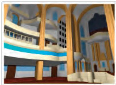
EASE JR utilise une approche statistique basée sur les formules de Sabine et Eyring pour le calcul du temps de réverbération. Cette méthode suppose que le champ sonore à l'intérieur de la pièce est homogène. Ces types de champs sonores sont plus couramment rencontrés dans les pièces où l'absorption est répartie de manière homogène sur ses surfaces et où sa géométrie ne propage pas la concentration d'énergie dans des points spécifiques.
