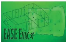
EASE Evac fournit un outil intuitif pour concevoir des systèmes d'évacuation acoustique dans une pièce, un hall ou un complexe de bâtiments. Le logiciel de simulation 3D calcule la distribution des niveaux sonores directs ainsi que les niveaux sonores totaux, le rapport signal sur bruit (SNR) et l'intelligibilité de la parole (STI, ALCons, CIS). Ces derniers calculs sont basés sur l'acoustique statistique de la salle.
